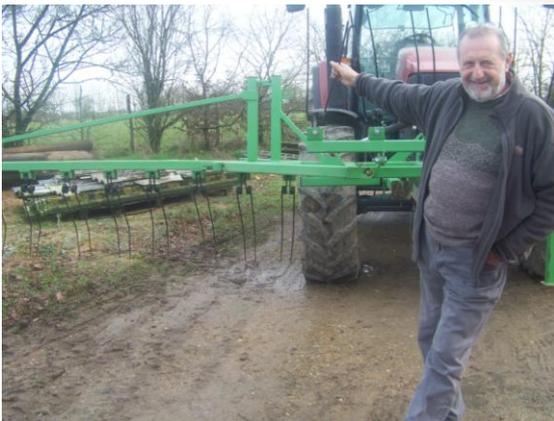
Le 21 décembre, la Fédération des Chasseurs de la Sarthe a accueilli plusieurs agriculteurs du réseau A.R.B.R.E. pour présenter ses travaux sur la barre d'effarouchement. Elle a développé un système de barres équipées de peignes et d'un vérin hydraulique pour le repli de la barre sans descendre du tracteur.
